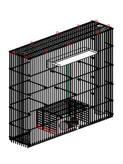
STEP 14 fissaggio del coperchio tramite anelli di chiusura
